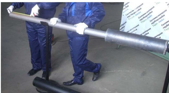
2. Приварить к металлической трубе болт М8/16 (расположить на 12 часов) на расстоянии 450 мм от торца трубы, где отсутствует заглушка.
