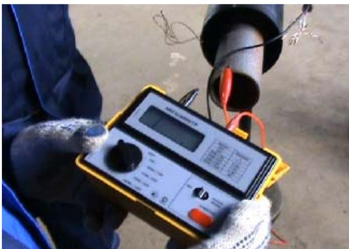
31. Проверить целостность сигнальных проводников – измерить сопротивление проводов.
